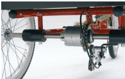
862 Cambio a tre velocità elimina la possibilità di pedalare all'indietro. Solo per le misure 3, 4, 5, 3D, 4D e 5D.
